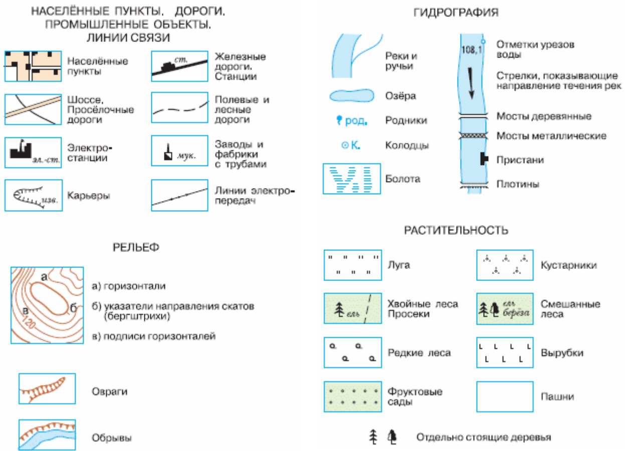
Рисунок 2 - Условные знаки на топографической карте (по: География. Современная иллюстрированная энциклопедия, 2006 и Словари и энциклопедии на Академике - http://dic.academic.ru/dic.nsf/enc_geo/7304/%D1%83%D1%81%D0%BB%D0%BE%D0%B2%D0%BD%D1%8B%D0%B5 )
